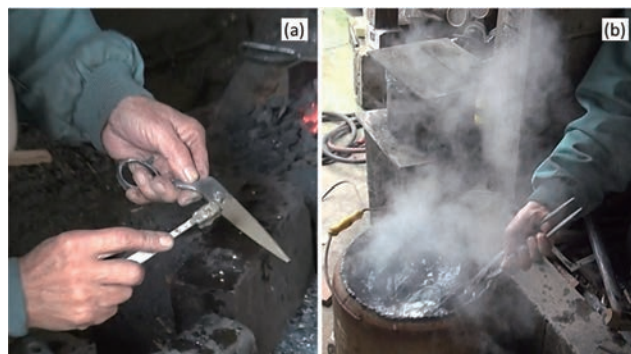
図4 (a)刃の表面に荒木田土を塗る、(b)急冷中に鋳を容器に押し付ける
