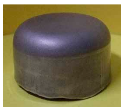
図2 AC3Aの深絞り試験の結果(LDR:1.9)
