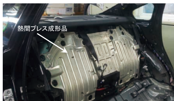
図3 ルノー・サムスン自動車が開発し、量産するMg合金製大型熱間プレス成型品。素材はPOSCOが提供。重量1.4kgで、従来品より2.2kg(61%)の軽量化に成功。
