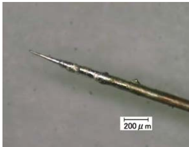
図3 溶融はんだによる極細電線の溶融・破断
