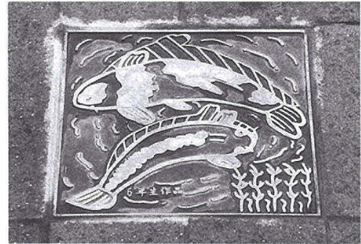
地元小学生が描いた図をもとに感光性樹脂模型から製造した鑄造品の例
