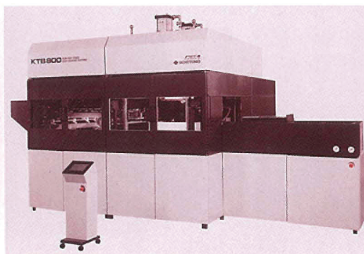
図2 熱可塑性ACM量産成形機(KTB-800)
