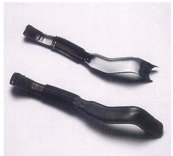
写真 2 エアインテークダクト
